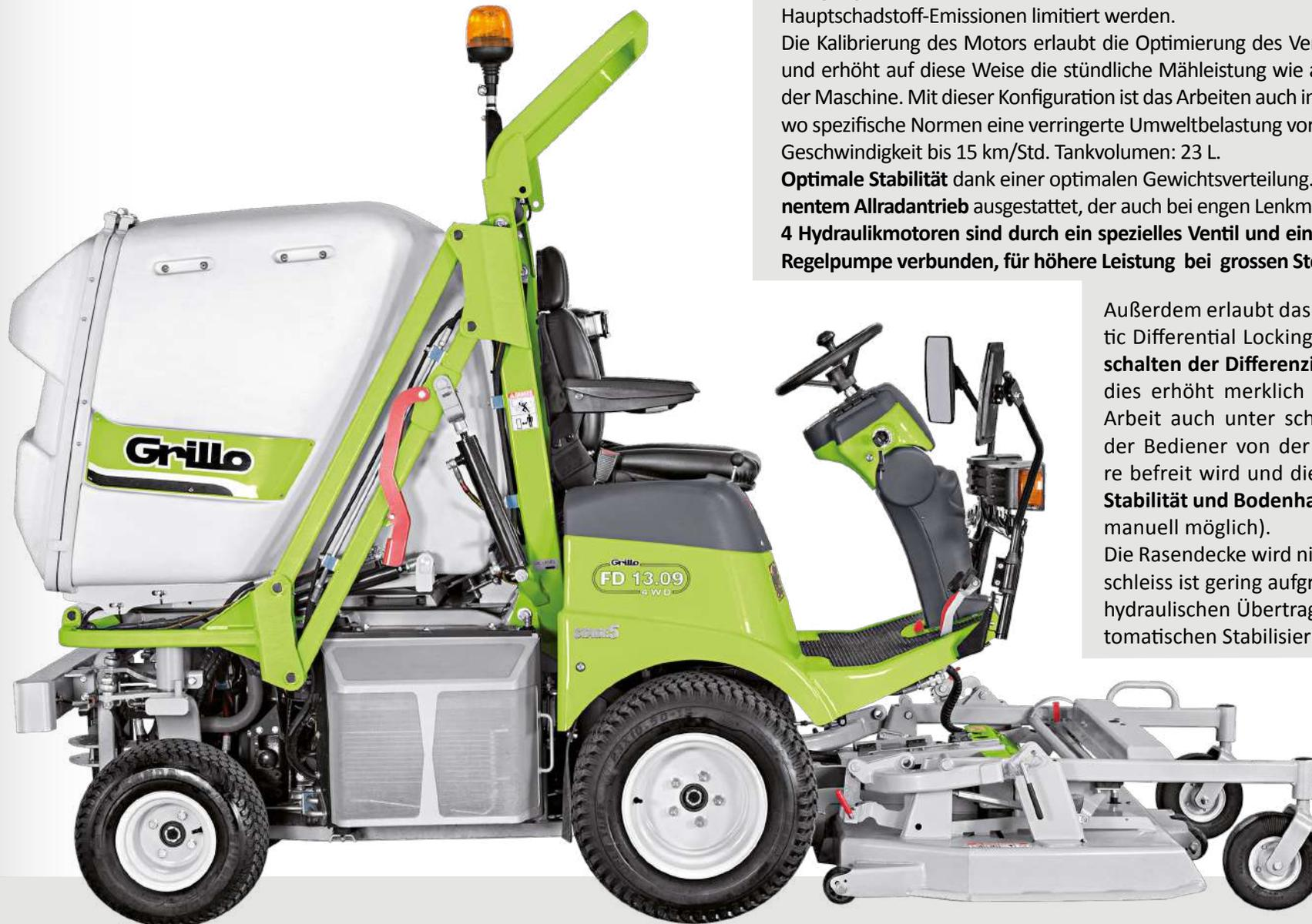
Der **FD 13.09** ist mit einem 3TNV82A **STAGE 5** Dieselmotor mit 1331 cc (26 PS bei 2800 U.p.M.) ausgestattet. Flüssigkeitskühlung mit Elektrogebläse und mit manueller und automatischer Kühlerreinigung. Der Motor schützt Umwelt und Gesundheit des Menschen, indem die wichtigsten Hauptschadstoff-Emissionen limitiert werden.
