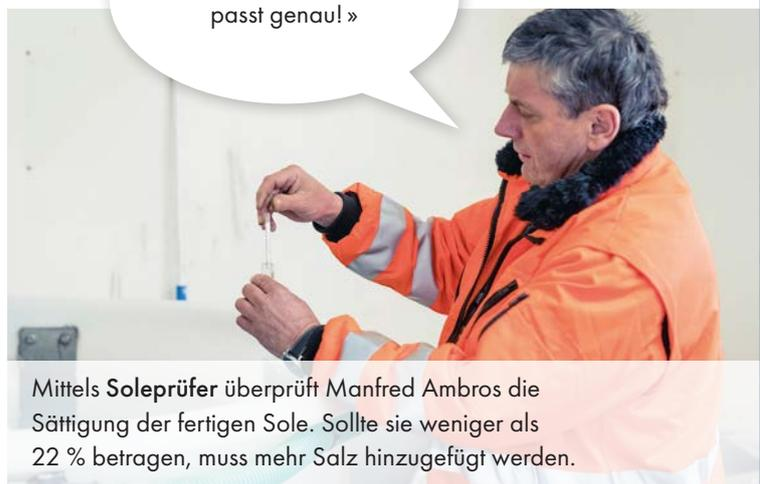
Mittels Soleprüfer überprüft Manfred Ambros die Sättigung der fertigen Sole. Sollte sie weniger als 22 % betragen, muss mehr Salz hinzugefügt werden.
