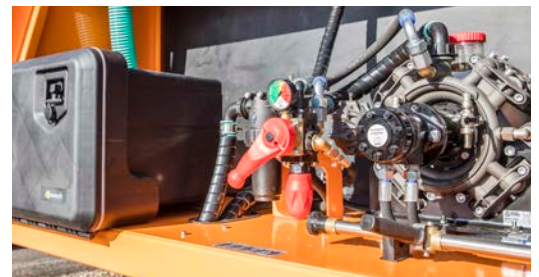
Pumpeneinheit mit Druckregler und optionaler Werkzeugkiste
