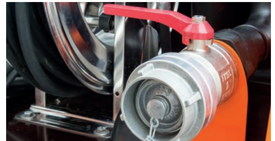
C-Anschluss mit Absperrhahn und freier Fließstrecke
