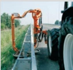
Questo senza rallentare la velocità di avanzamento e/o cambiare la direzione di marcia della trattore e senza nel contempo fermare il taglio dell'erba da parte della lama interna
