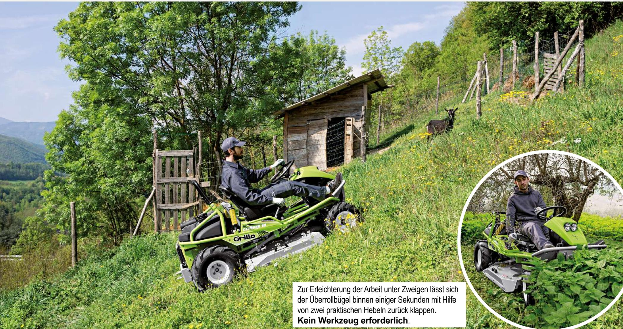
Zur Erleichterung der Arbeit unter Zweigen lässt sich der Überrollbügel binnen einiger Sekunden mit Hilfe von zwei praktischen Hebeln zurück klappen.
