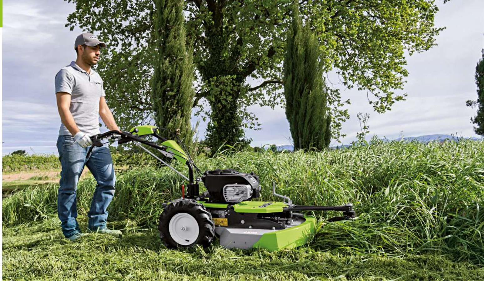
Der **CL 62** ist mit einem Intek 950E Series, OHV, Einzylinder Benzinmotor mit 223 cc Hubraum und 5,6 PS ausgerüstet. Treibstofftank Fassungsvermögen: 1,1 L.
