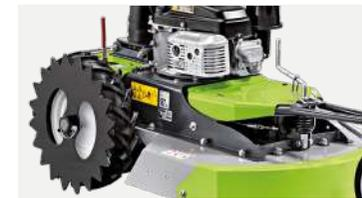
Am **CL 62M** können zusätzlich gezackte Scheiben aus Eisen als **Zubehör** montiert werden, um höherem Grip bei rutschigem Grund und an steilen Hängen zu erzielen.
