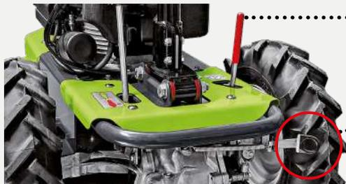
Beide Modelle verfügen über eine **Parkscheibenbremse**, die in der Lage ist, die Maschine auch in Hanglage stabil zu halten.
