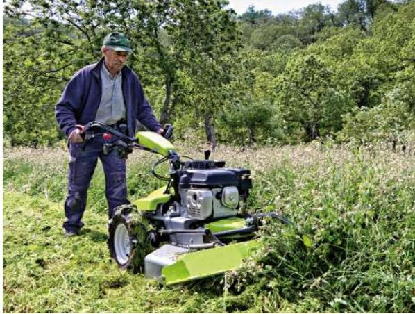
Der **CL 75** verfügt über einen Benzinmotor Modell GXV 390. Der 1-Zylinder- Motor hat 389 cc Hubraum und hat moderne Lösungen, die dessen Zuverlässigkeit garantieren, wie z.B. oben liegende Ventile, **geringe Abgasemissionen, niedriger Verbrauch, hohe Leistungen und aufs Mindeste reduzierte Vibrationen.**
