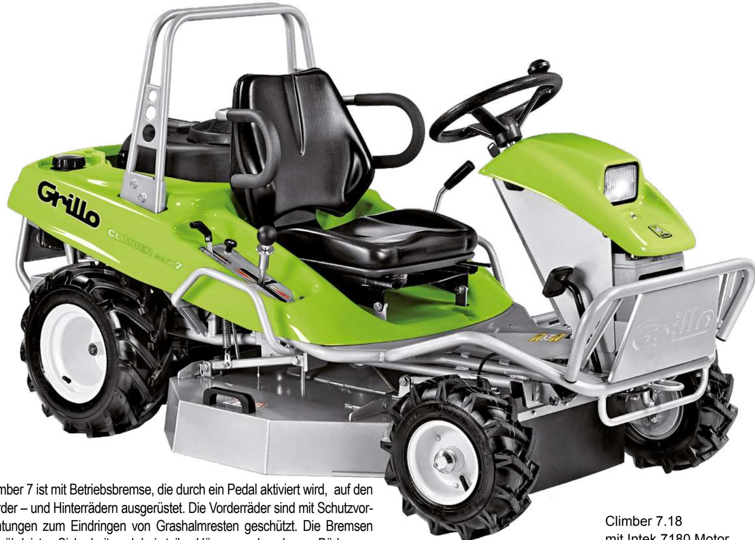
Climber 7 ist mit Betriebsbremse, die durch ein Pedal aktiviert wird, auf den Vorder – und Hinterrädern ausgerüstet. Die Vorderräder sind mit Schutzvorrichtungen zum Eindringen von Grashalmresten geschützt. Die Bremsen gewährleisten Sicherheit auch bei steilen Hängen und unebenen Böden.
