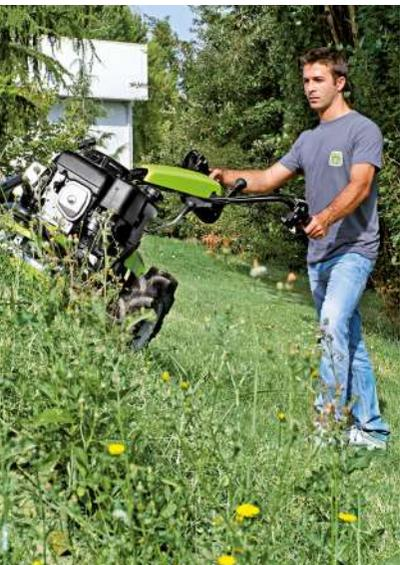
Beim Mähen entlang des Hangs ist es möglich, das Vorderrad zu blockieren, was die Arbeit erheblich erleichtert. Darüber hinaus ist der Motor mit einer **Ölpumpe** ausgestattet, der das Arbeiten in Hanglage erlaubt, ohne dass der Motor beschädigt wird.
