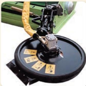
Ruota interfileare idraulica, per il taglio dell'erba tra una pianta e l'altra.
