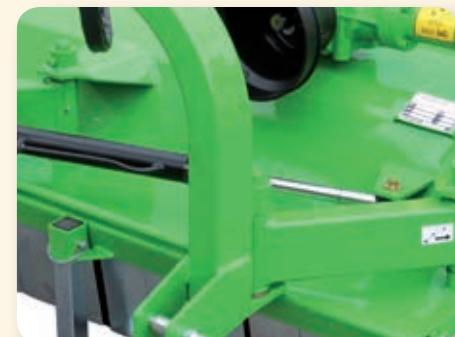
Spostamento idraulico dell'attacco a 3 punti
