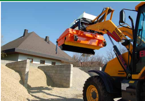
LIG hydraulische Schmutzsammelbehälterentleerung am Radlader
