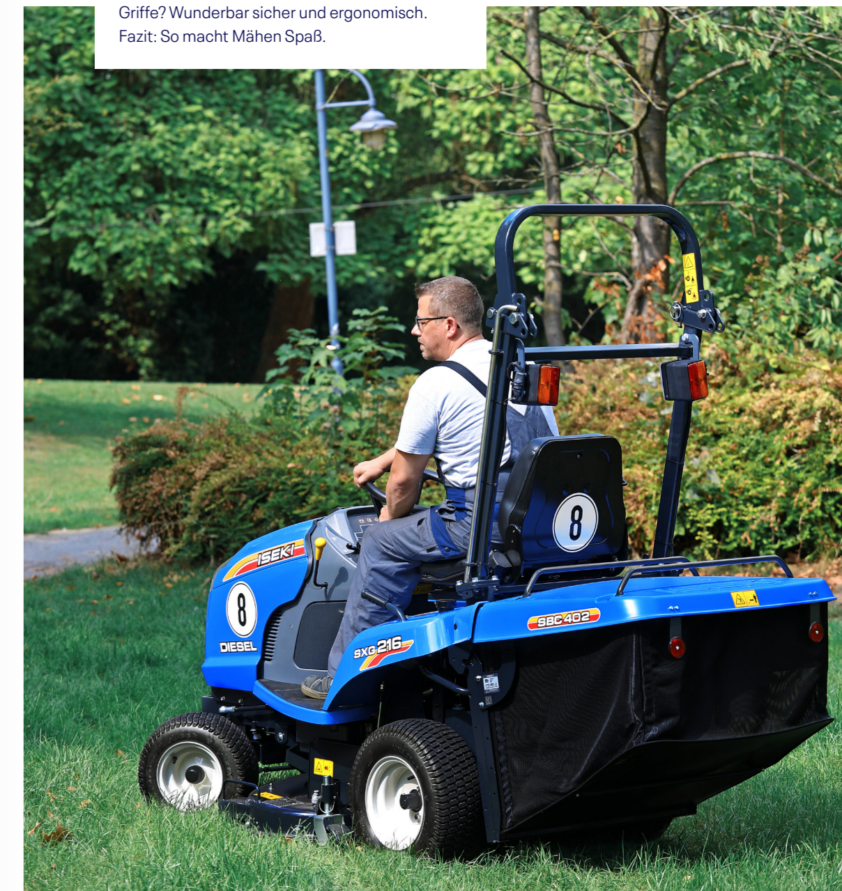
Große Wiesenfläche oder enge Durchfahrt – mit einer Außenbreite (über alles) von 1.070 mm passt die Sache.
