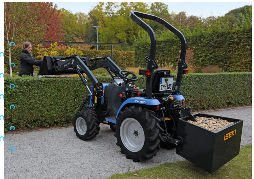
Der Ballastkasten schafft das nötige Gegengewicht selbst bei schwerem Aushub im Frontlader.
